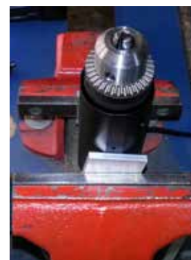
Figura 4 – Visão geral do aparelho usado no estudo com suporte metálico para fixação do implante durante a medição do torque.
